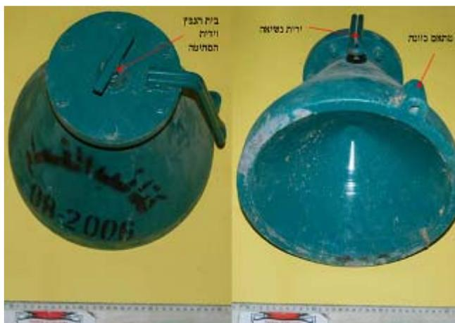
Charge explosive *Shawaz* à effet dirigé fabriquée par le I le e par le Hamas et découverte le 12 septembre 2006. Capacité de pénétration de blindés : plus de 200 mm d'acier
